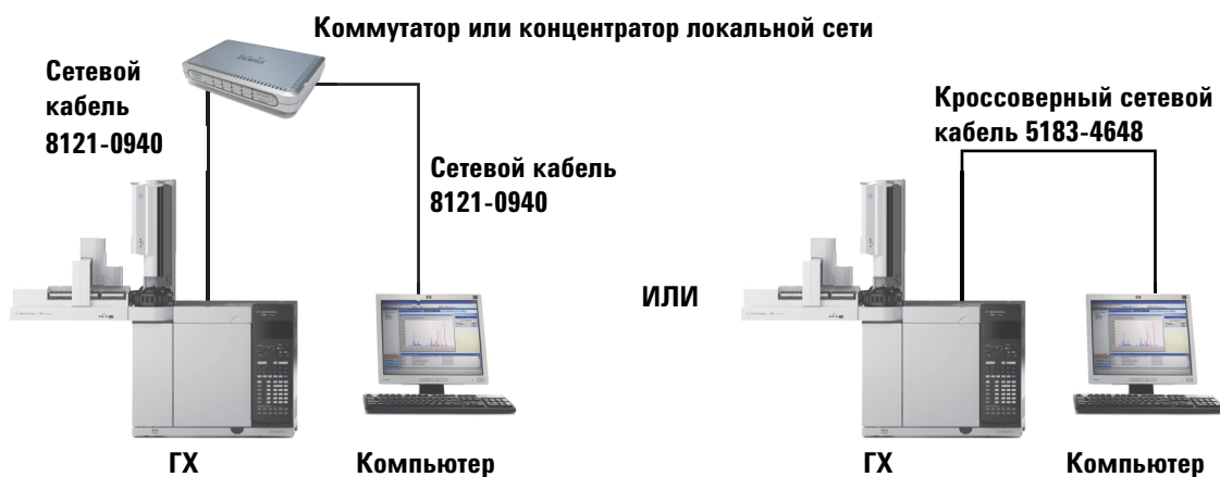
Рисунок 5 Простые поддерживаемые конфигурации LAN: Коммутатор или концентратор локальной сети (слева) и прямое подключение (справа)
