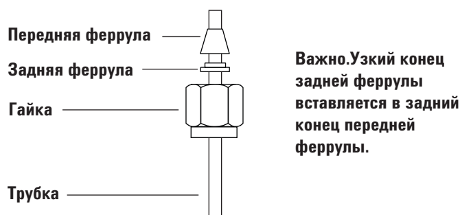
Рисунок 17 Гайки Swagelok и феррулы
